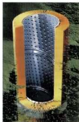
Innenansicht des Feinstfilters. Das Papierfaltelement hat eine Filteroberfläche von 1,7 m 2 und verspricht einem Durchlaufdruck von mehr als 1,5 bar standzuhalten.
