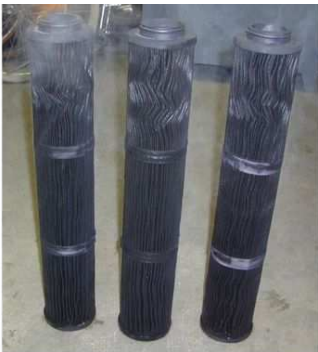
Verschmutzte Filterelemente vom Hamburger Airport. Die Filterkerzen können über den normalen Hausmüll entsorgt werden.
