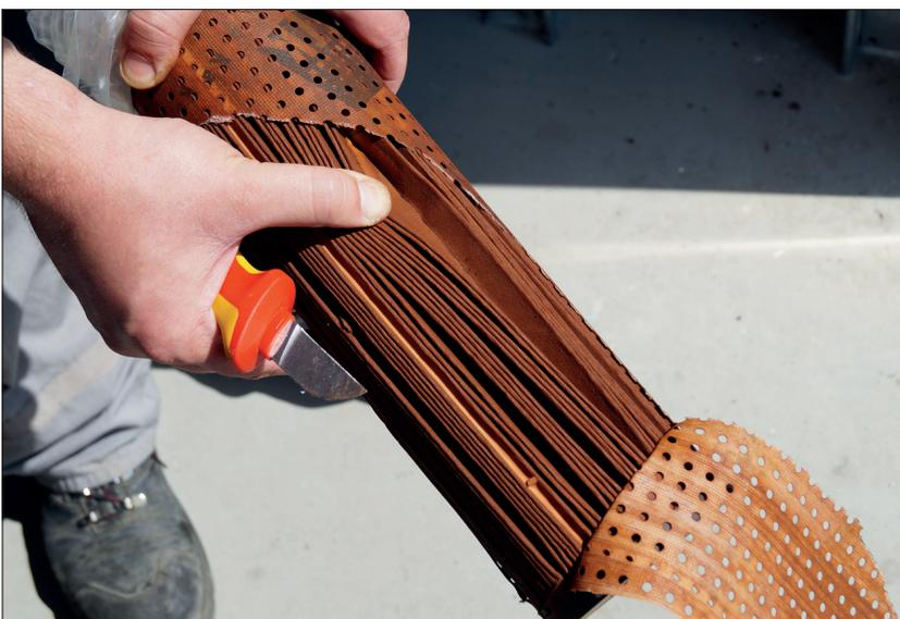
*Bild 4. Beim Filterwechsel in Heuchelheim deutet die rot-braune Ablagerung klar auf ein Korrosionsprodukt hin – ohne Filter könnten sich diese Teilchen im Wärmeübertrager oder Kessel ablagern* Quelle: Angster
