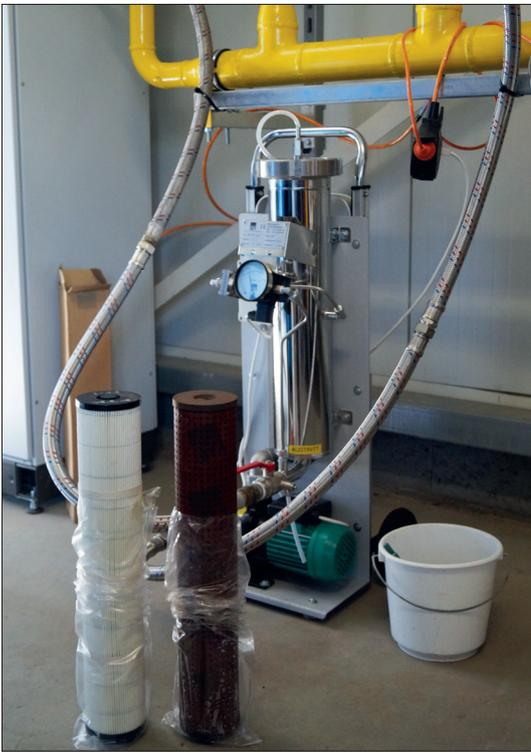
*Bild 2. Bei den SWG sind derzeit 30 Reflux-Feinstfilterstationen in der mobilen Ausführung im Einsatz; links ein neuer, rechts ein gebrauchter Filter*
