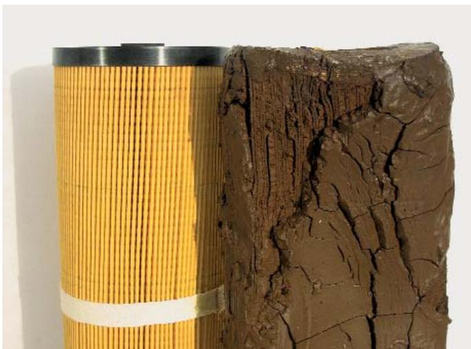
Links sauber und rechts total verschlammmt: Unschwer zu erkennen, welche Vorteile der Einsatz der FTK-Filtertechnik für die gesamte Heizungsanlage bietet. (Werkbild)
