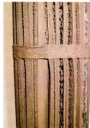
▲ Das Bild zeigt ein vollkommen verschmutztes Filterelement. Über ein Lichtsignal wird dieser Zustand angezeigt und die Anlage schaltet sich ab. Die Filterkerzen sind aus einem Spezialpapier und können über den normalen Hausmüll entsorgt werden.
